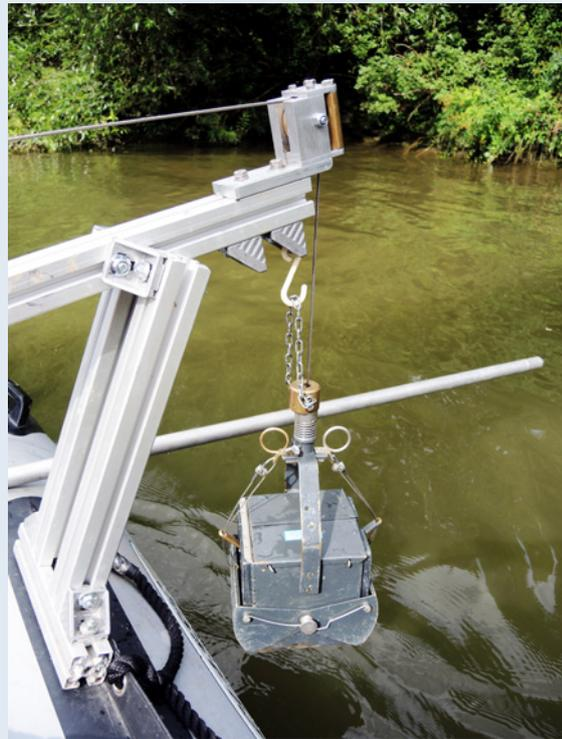
**Bild 4.2:** Sedimentprobenahme zur Analyse auf organische Phosphonate.
