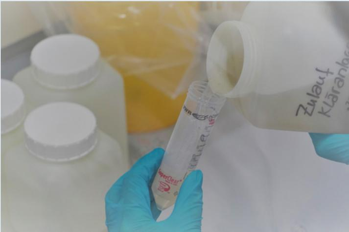
**Bild 4.7:** Proben aus einem Kläranlagenzulauf.
