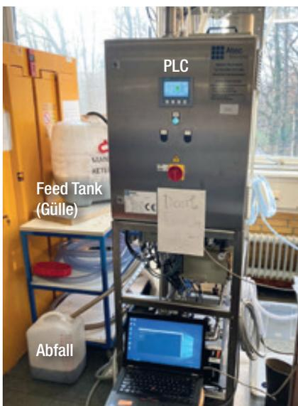
Abb. 2: MF-Anlage für keramische Membranen
