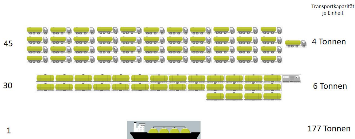
Abbildung 7-4: Vergleich der Transportkapazitäten für LKW, Gütertransport und Binnenschiff beispielhaft für den H_2 -Transportvektor LH_2 .
