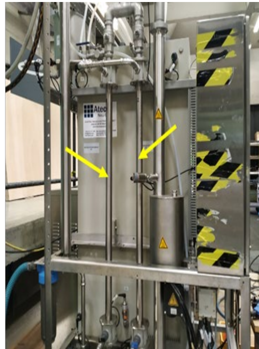
Abbildung 15. Kammerfilterpresse mit mehreren Kammern (Filtertücher mit 100 µm Maschenweite) (links); Querstrom-Mikrofiltration mit Keramikmembranen (Röhren mit Membranen mit Pfeilen gekennzeichnet; Länge je 1 m, Porengröße 0,2 µm) (rechts).
