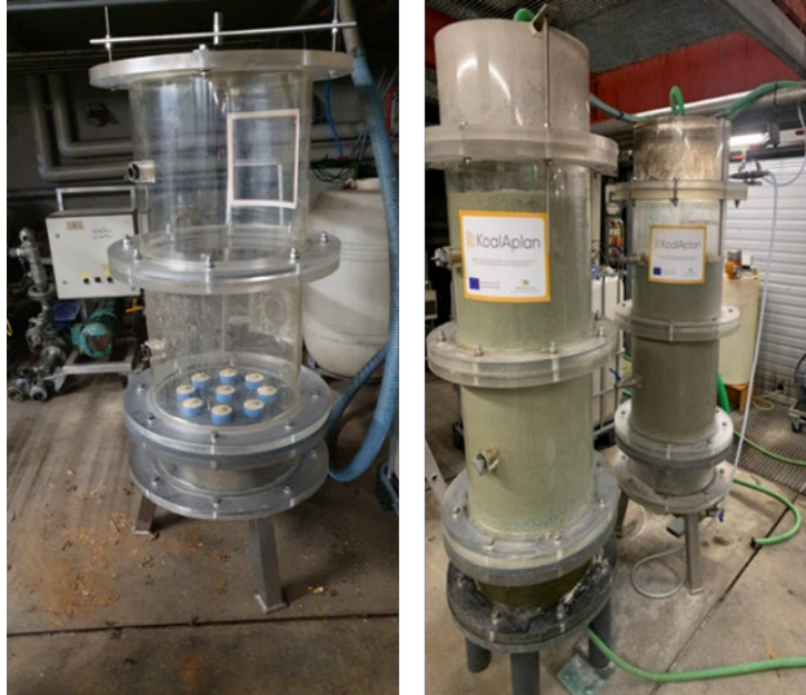
Abbildung 9. Halbtechnische Ionenaustauscherkolonne (links leer, rechts gefüllt)
