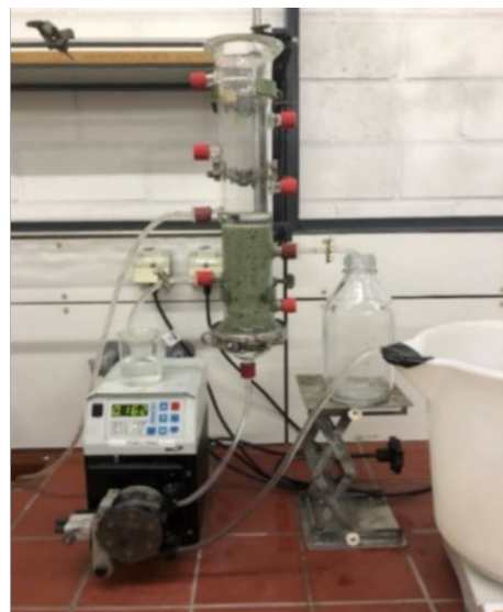
Abbildung 6. Ionenaustauscher Verfahrensfließbild (links), Laborglassäule im Labormaßstab (rechts)
