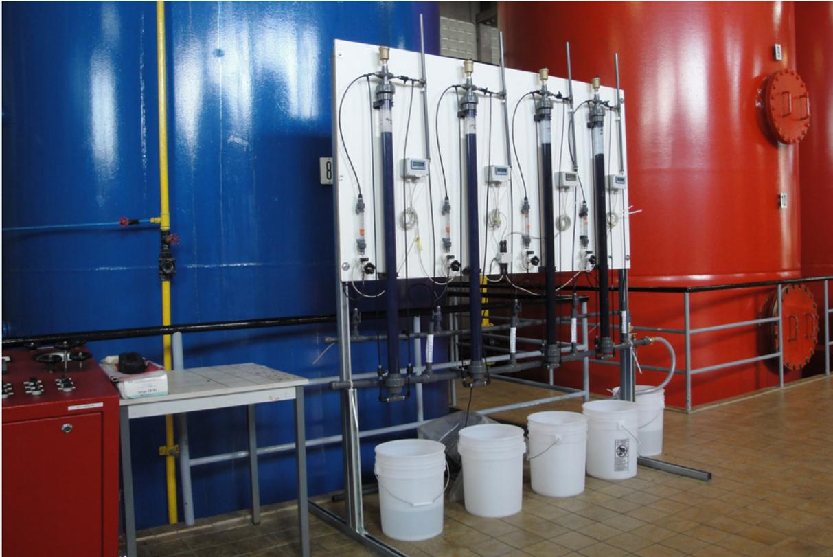
**Bild 4.2:** GCS-Teststand zum Vergleich verschiedener Aktivkohlen zur Spurenstoffentfernung
