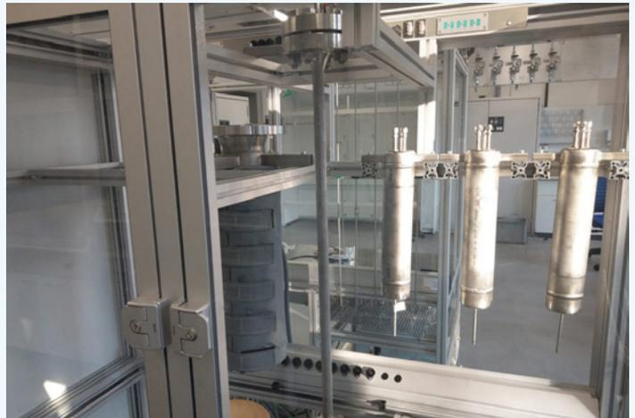
**Bild 1.11:** Links: 3D-Modell des Hochdruck-Festbettreaktors; rechts: Blick in die Anlage mit Reaktor und Abscheidebehältern
