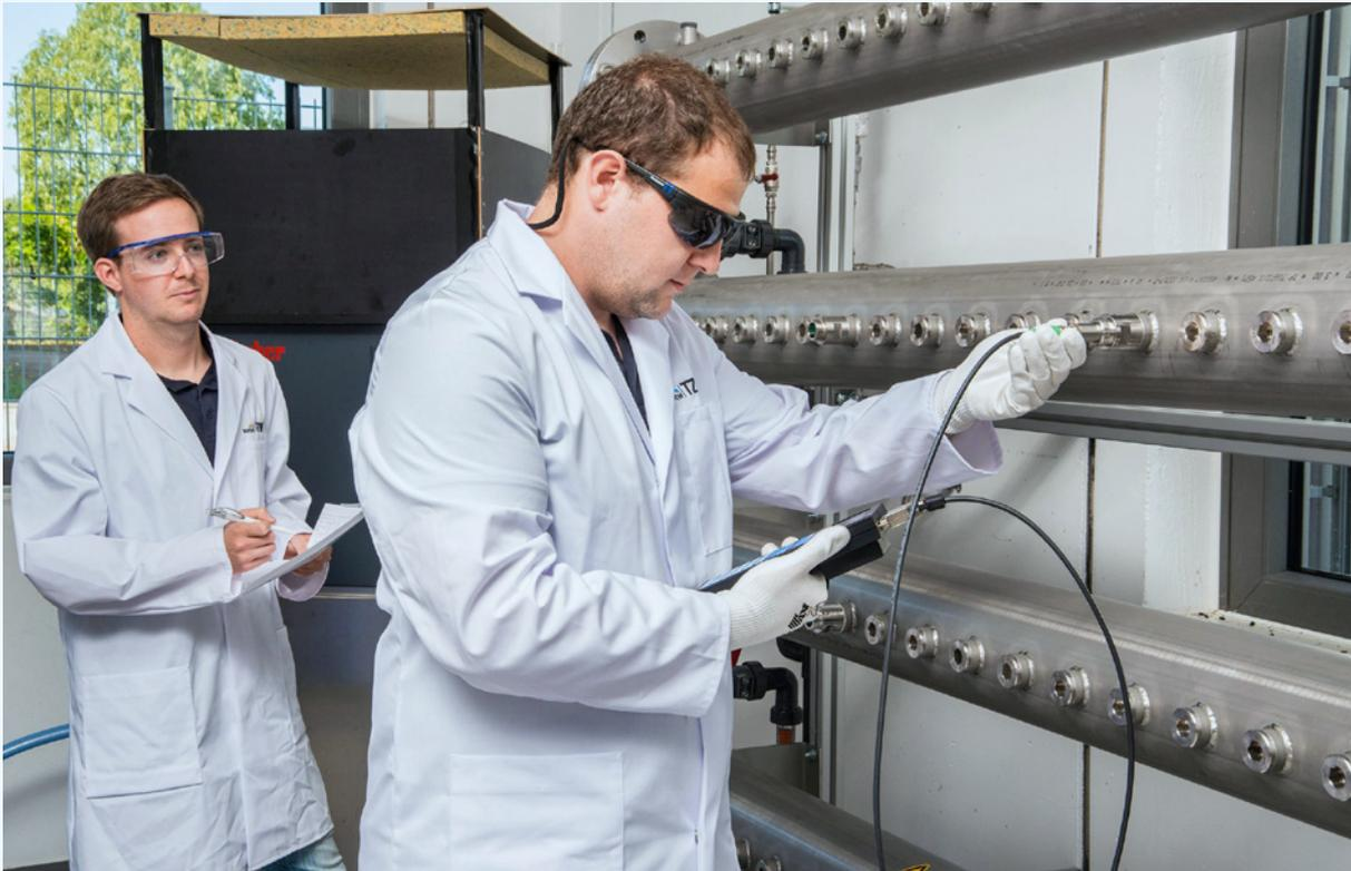
**Bild 4.6:** Messung von UV-Lampen in Testreaktoren
