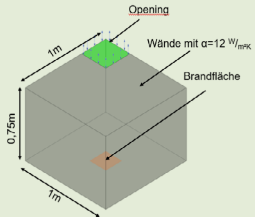
Bild 2.13: Simulationsgeometrie für die brandlast- und ventilationskontrollierten Brandereignisse
