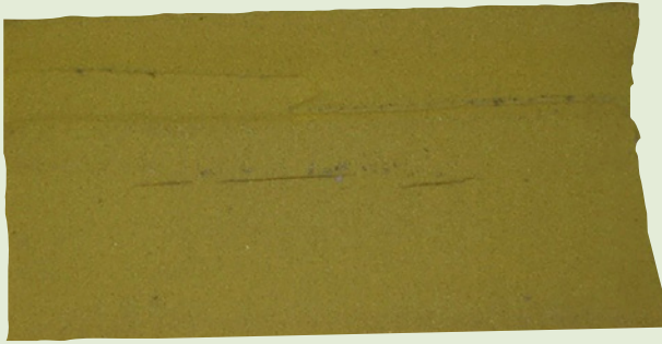
Bild 1.26 li.,re.: Durch RGD an HNBR-Werkstoffen generierte Schadensbilder: nach 2 x 24 h, 130 bar H 2 (li.), nach 2 x 24 h, 130 bar CH 4 (re.)
