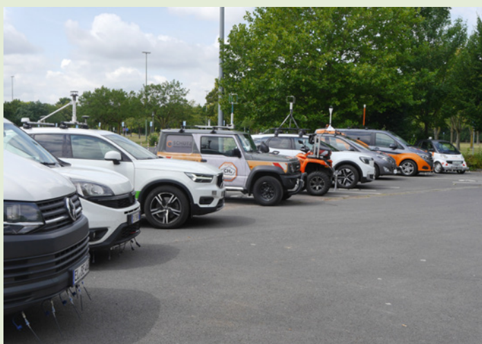
Bild 1.29: Fahrzeugunterstützte Messtechnik zur oberirdischen Überprüfung von erdverlegten Gasleitungen Quelle: DVGW-EBI
