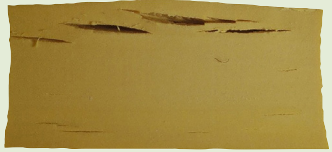
Bild 1.26 li.,re.: Durch RGD an HNBR-Werkstoffen generierte Schadensbilder: nach 2 x 24 h, 130 bar H 2 (li.), nach 2 x 24 h, 130 bar CH 4 (re.)
