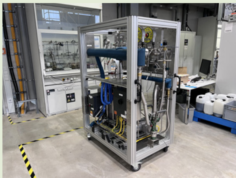
Bild 1.32: Mobiler LNG-Sampler zur Beprobung von LNG-Tankstellen
